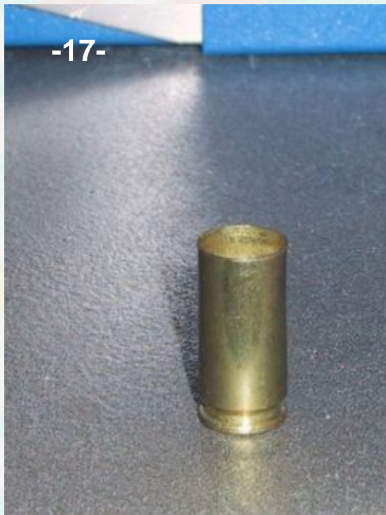
Così si presenta il bossolo dopo la svasatura (foto 17)
