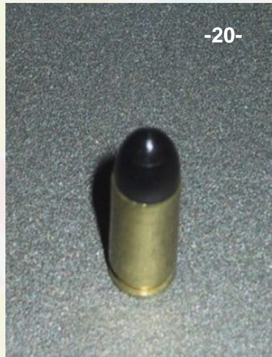
Così si presenta la munizione finita nel calibro 9x21 (foto 20)
