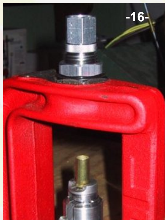
E' consigliabile svasare leggermente la bocca del bossolo così da rendere più agevole l'inserimento della palla (foto 16)
