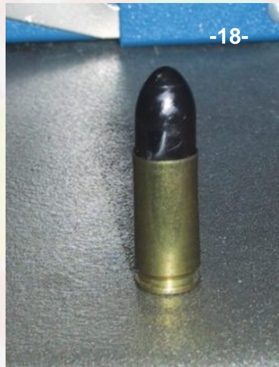
Siamo adesso pronti per inserire la palla nel bossolo (foto 18)
