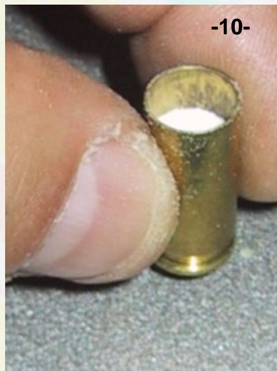
E' poi consigliabile battere leggermente il bossolo su un piano rigido al fine di meglio costiparne il contenuto (foto 10)
