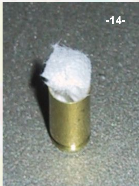
Il velo di carta andrà inserito all'interno del bossolo e costipato al suo interno (foto 14)
