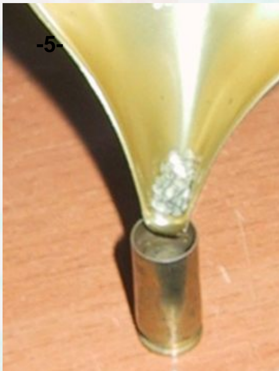
La dose di polvere verrà versata nel bossolo (foto 5)
